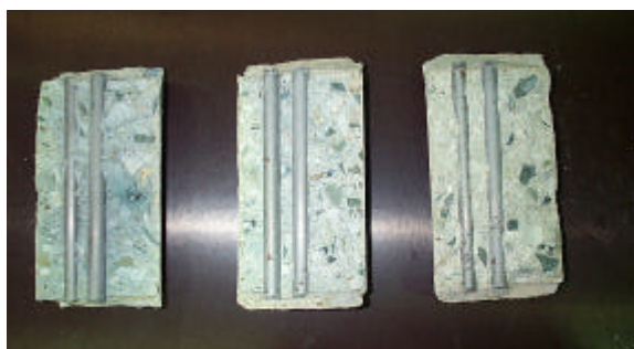
<그림-3> 부식속진시험용 공시체의 형상 및 부식면적을 선정방법
